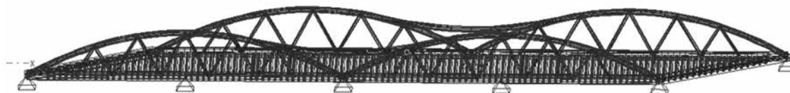
Figura 21. Puntos de apoyo de la estructura en la situación inicial del empuje
